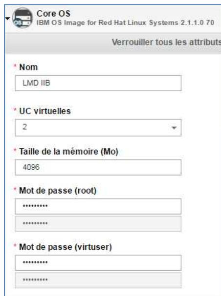
Il s'agit ici d'une VM avec 2 vCP et 4 Go de mémoire, sur un RHEL. On va également dans cette étape spécifier le mot de passe de root et de « virtuser », compte utilisé par Pure Application pour les déploiements.
